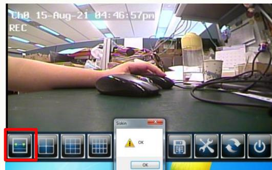
伺服器端開啟 CMX.exe，並點“Enable”開啟連線監控尋找前端資訊。找到前端裝置後按右鍵點選 Start Capture 並點選 Preview 即可監控前端影像。
