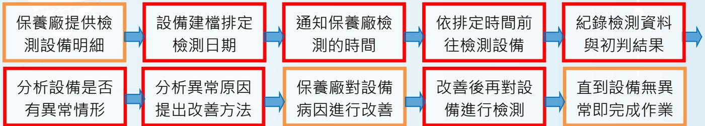
↑ 圖一 檢測作業流程圖
