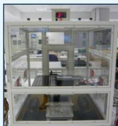
將主機板置入**自然對流恆溫箱**，溫度設置在 **50°C**，並測量元件溫度
