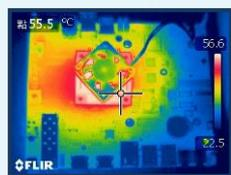
透過**紅外線熱像儀**可得**(室溫)元件溫度分布圖**
