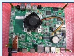
主機板在(室溫)下燒機，燒機指的是在透過軟體將系統的負載拉到最高
