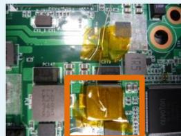
將溫升線黏製元件表面，可從**元件溫度分布圖**來得知哪些元件需要黏溫升線
