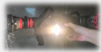
圖(八) 流體驅動消防瞄子燈燈光檢查
