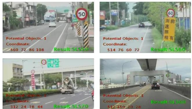
這裡選擇50、60、70公里，三個市區中最常見的限速標誌來做為實驗成果的呈現。目的在於研究此系統是否在目標大小及場景變換的情況下，依舊能達成限速標誌辨識功能，並於高架道路環境實際進行測試，成功完成限速標誌辨識。
