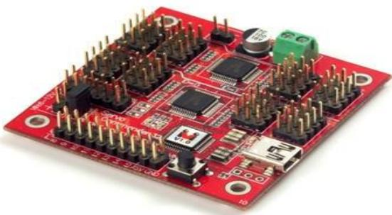
利基Servo Commander 32模組結合了BASIC Commander - BCI與兩個Servo Runner A，使用者能大幅縮小模組所需要面積，減少連接線材，並完整保留Servo Runner A的所有功能：可以一次控制三十二個伺服機。
